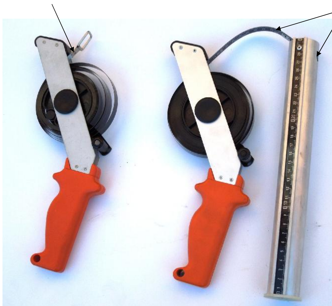
Фотография 1 - Общий вид рулеток и места нанесения знака поверки
