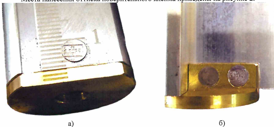
Рисунок 2 – Места нанесения оттиска поверительного клейма на метроштоки с поперечным сечением профиля: а) круглым; б) тавровым
